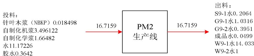
图 3-33一期静电复印纸、双胶纸 PM2 生产系统总水平衡图 单位: t/t 产品
